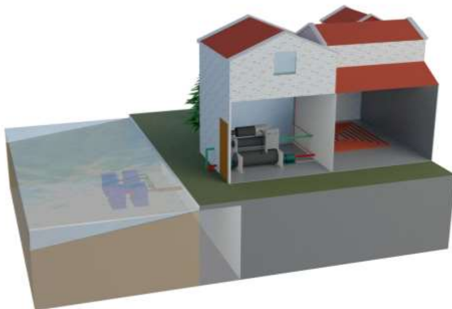
新型海水源热泵系统基本构成
