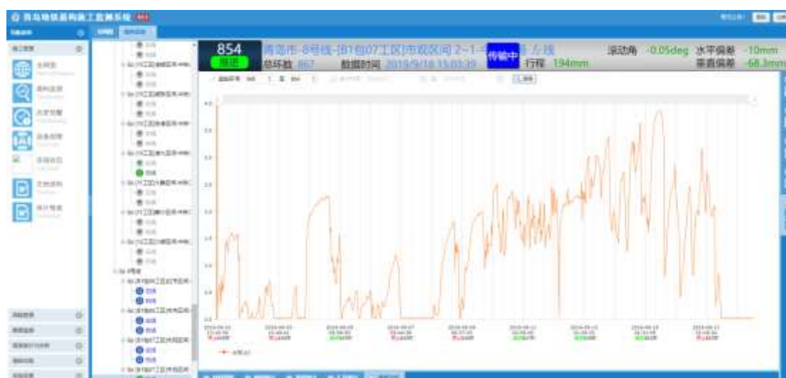
盾构施工全过程实时监控管理系统
