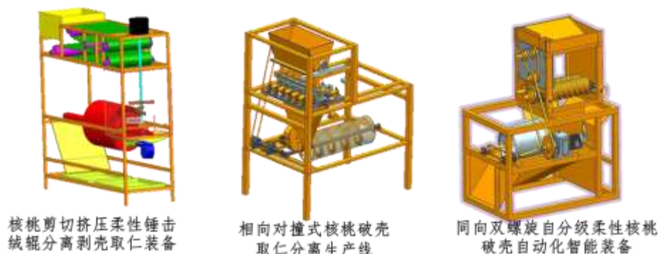
图 2 核桃柔性破壳取仁装置
