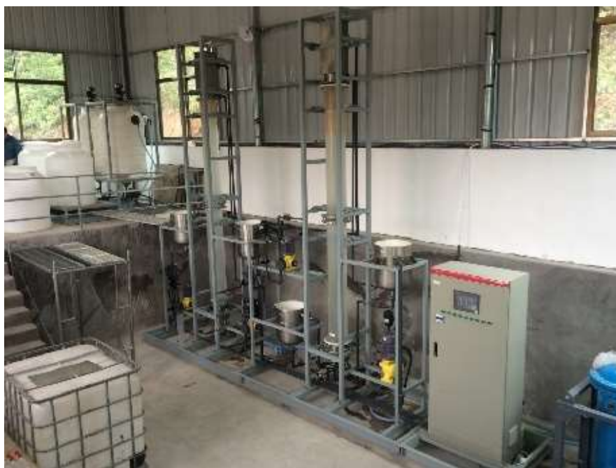
图 1 气泡支撑有机液膜萃取处理黄金冶炼
